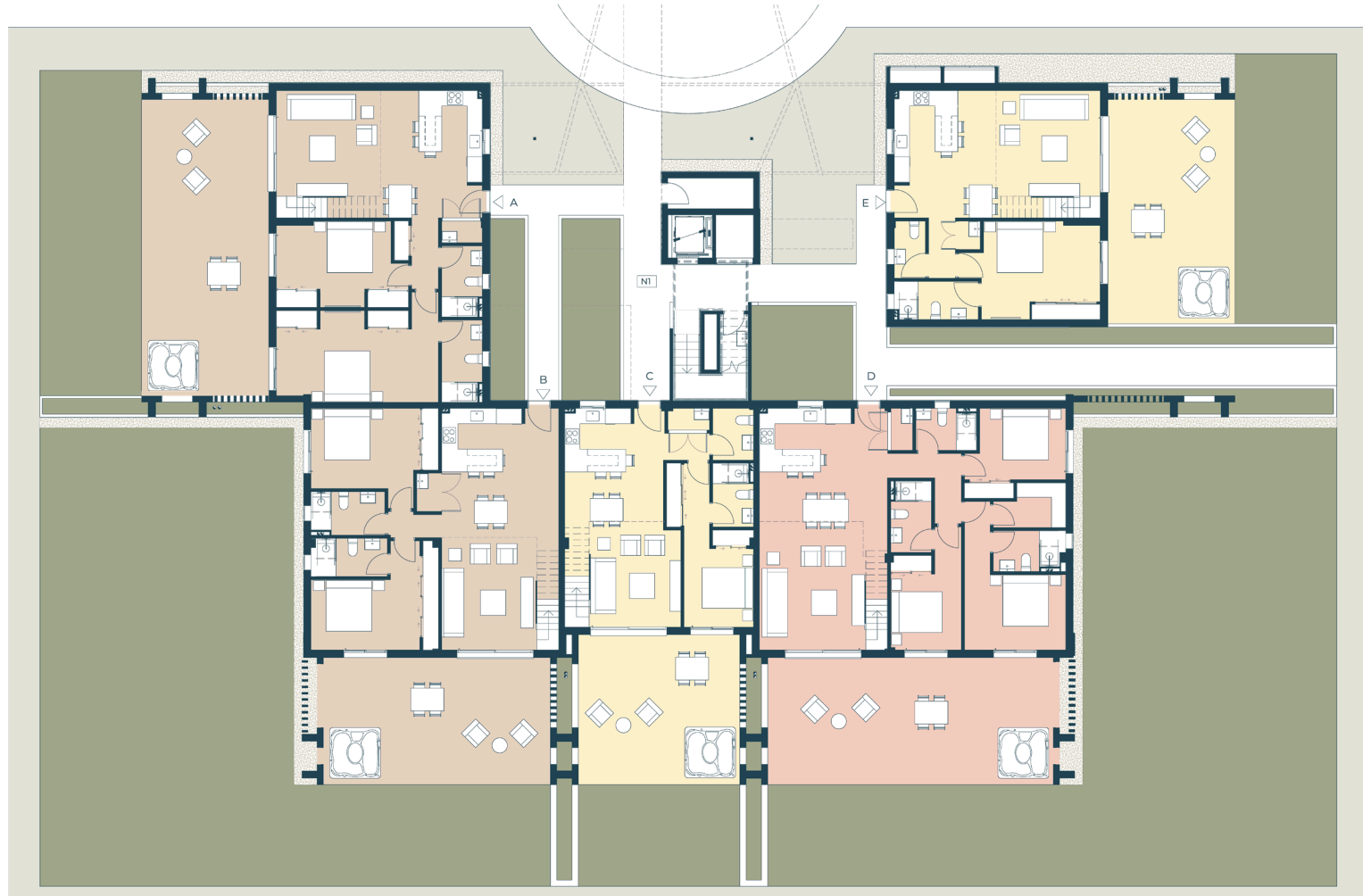
BLOQUES 2 Y 4 NIVEL 1 ESCALA 1:150
